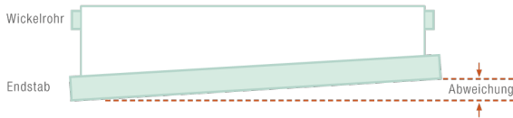
Abbildung 33: Abweichung von der Rechtwinkligkeit
